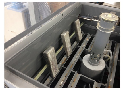
塩水噴霧試験実施状況 (一般財団法人日本塗料検査協会 実証済み)
